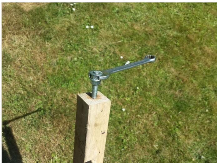
**i** Pour l'axe avant: faire un perçage de 8 mm au milieu de l'axe, traversant le tasseau (pour le fixer juste au milieu et faire la direction)
