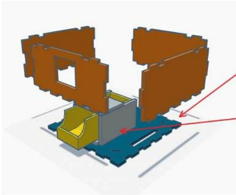
Attention, les trous de centrage ne sont pas bien positionnés pour permettre de s'empiler parfaitement avec la partie des boîtes d'Arthur.
