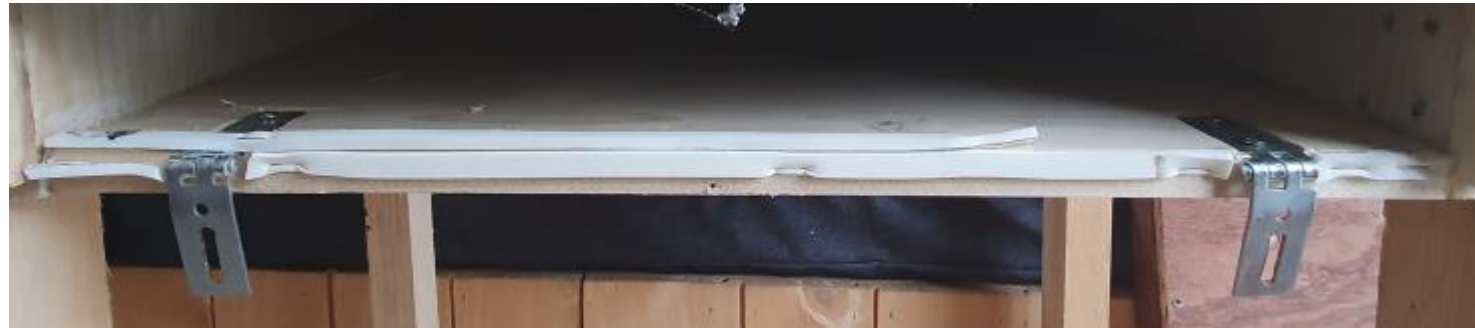
Charnières pour pivotement du capteur solaire (détails et fixations en bas du caisson de séchage)
