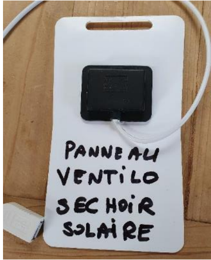
Face arrière du Panneau Photovoltaïque qui délivre du 5V continu sous 5W max
