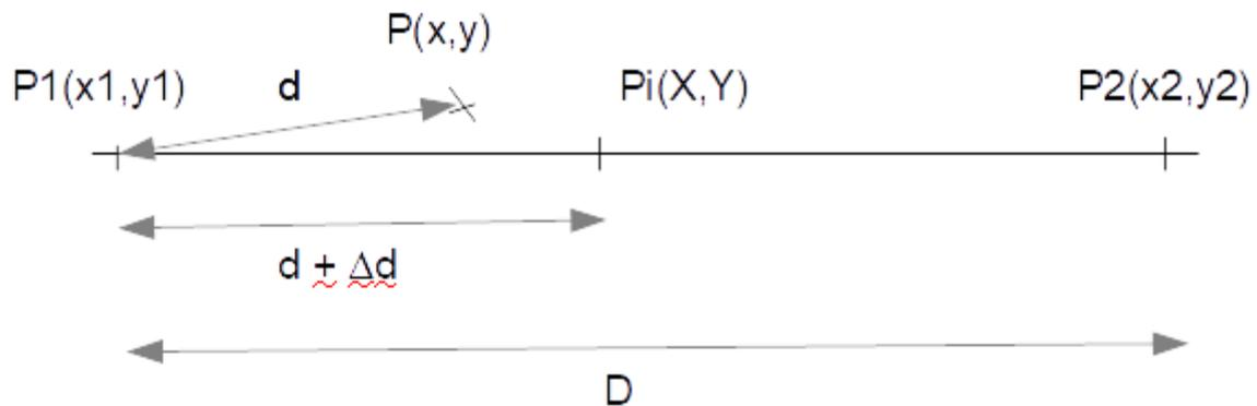
Soient P1 et P2 les deux points entre lesquels la machine se déplace. Ces deux points sont donnés dans le fichier de points par leurs coordonnées dans le repère géographique (celui du GPS), soient P1 (x1, y1) et P2 (x2,y2).
