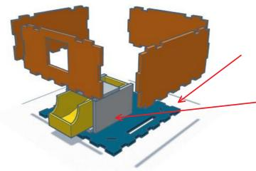
Attention, les trous de centrage ne sont pas bien positionnés pour permettre de s'empiler parfaitement avec la partie des boites d'Arthur.
