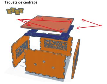
Attention, les trous de centrage ne sont pas bien positionnés pour permettre de s'empiler parfaitement avec la partie des boites d'Arthur.
