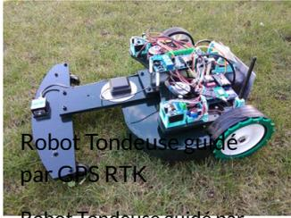
Robot Tondeuse guidé par GPS RTK
