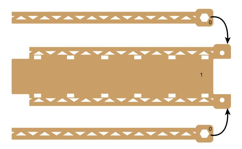
Une fois les pièces collées, introduire les écrous dans les emplacements et les maintenir à l'aide d'un adhésif type scotch de peintre.
