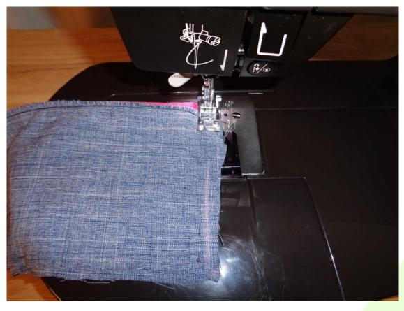
On continue de coudre en veillant à retirer les épingles au fur et à mesure. Une fois dans un coin il suffit de lever le levier et de tourner le tissu dans le bon sens avant de rabaisser le pied-de-biche. N'oubliez pas d'ouvrir la fermeture avant de terminer les derniers côtés sans quoi vous ne pourrez plus l'ouvrir.
