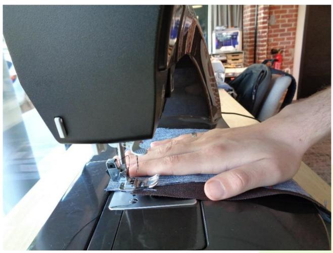
Lorsqu'on est arrivé au point de départ on appuie sur le bouton de marche arrière pour faire un point d'arrêt qui empêche les points de se découdre facilement. Il suffit alors de 4 ou points de couture. Une fois terminé on découpe le fil à l'aide du cutter de la machine.
